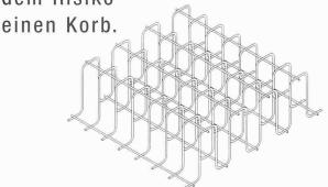
FIDECA®, die neuartige Schubbewehrung (Euro Pat.) von Fischer Rista, gibt Gebäuden schon beim Bauen mehr Sicherheit. Die Schubkörbe mit ihrer wellenförmigen Konstruktion ermöglichen eine kontinuierliche Verankerung. So wird das Risiko des Durchstanzens durch Bodenplatten oder Betondecken ausgeschlossen.
