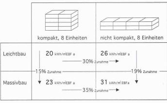
Graue Energie von Passivhäusern in Leicht- und Massivbauweise: kompakte und nicht kompakte Gebäudevolumen im Vergleich
