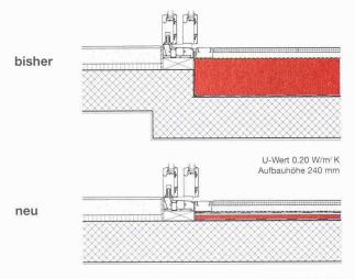
U-Wert 0.20 W/m2 K Aufbauhöhe 105 mm
