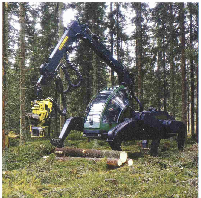
Sechsheinige Schreit-Erntemaschine (Konzept-Maschine der Firma Plustech Oy, Tampere, Finnland). Das Gehrprinzip ist die flexibelste Form der Fortbewegung in inhomogenem Gelände. Die Schrittmuster sind der Stabheuschrecke nachempfunden (Bild: Plustech Oy, Finnland)
