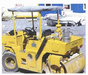
Der Partikelfilter an dieser Strassenwalze reduziert den Schadstoffausstoss – insbesondere an Russ – an der Quelle (Bild: BWL/Leuenberger)
