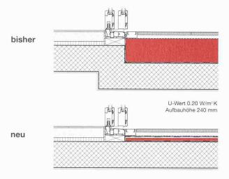
U-Wert 0.20 W/m2 K Aufbauhöhe 105 mm
