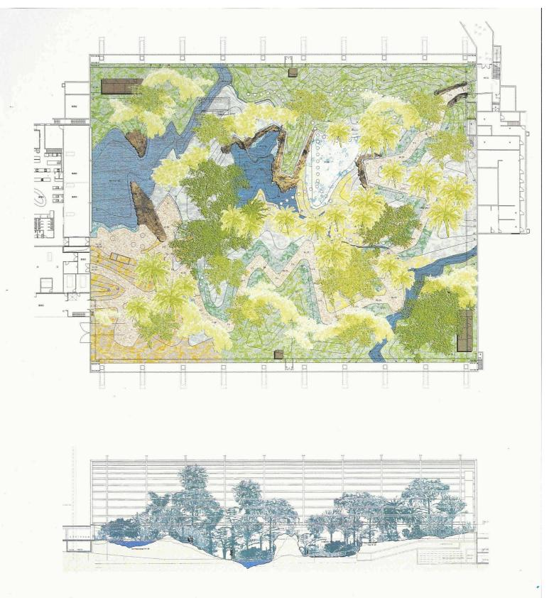
«Masoala-Regenwald»-Halle, Grundriss und Längsschnitt, M 1:100 Die Halle hat eine Grundfläche von 118 x 91m und vom Wasserspiegel des Weihers bis zum Scheitelpunkt des Bogenträgers eine Höhe von 35 m
