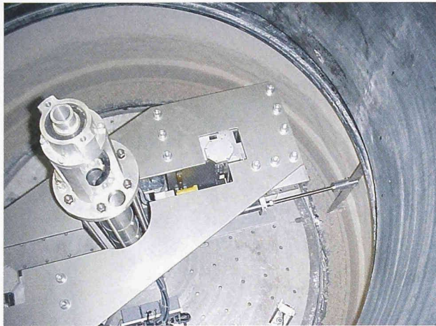
In der neuen Trommelzentrifuge am Institut für Geotechnik der ETH Zürich können Naturkatastrophen im Zeitraffer simuliert werden. Im Bild wird ein Bodenmodell (braune Schichten am Rand der Zentrifuge) auf seine Stabilität getestet (Bild: pd)
