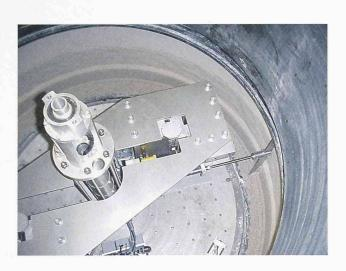
In der neuen Trommelzentrifuge am Institut für Geotechnik der ETH Zürich können Naturkatastrophen im Zeitraffer simuliert werden. Im Bild wird ein Bodenmodell (braune Schichten am Rand der Zentrifuge) auf seine Stabilität getestet (Bild: pd)
