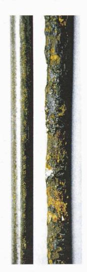
7 Intakter und stark korrodierter Spannstahl
