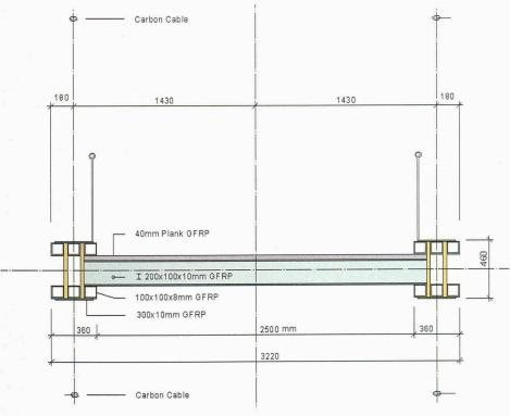
Querschnitt bei 30 m Spannweite und 2,50 m Breite
