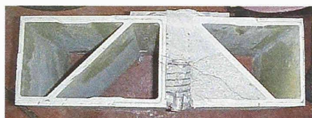
Kopfbolzenverbindung zwischen Stahlträger und FRP-Fahrbahnplatte (Bild: Martin Marietta Composites)
