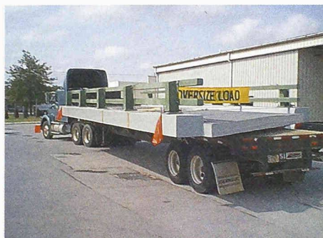
Vorgefertigte FRP-Brückenplatte (Bild: Hardcore Composites)
