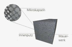
Paraffin in Mikrokapseln in der Putzschicht entzieht durch Schmelzen dem Raum Wärme (Bild: pd)
