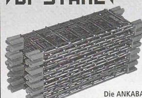
Die ANKABA DISTANZ-Armierung dient zur Erhöhung des Durchstanzwiderstandes von Flachdecken im Stützenbereich.
