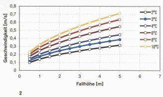
Maximale Grenzschichtgeschwindigkeit in Abhängigkeit von Fallhöhe (h) und Oberflächentemperaturdifferenz (zur Raumtemperatur von 20 °C); Beispiele: h = 3 m:  $\Delta\vartheta \leq$  2,2 °C; h = 4 m:  $\Delta\vartheta \leq$  1,3 °C
