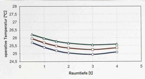
11 Einfluss der Deckentemperatur bezogen auf den Grundfall, Berechnung mit 20 (blau), 22 (rot) und 24°C (grün)
