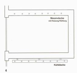
Bei der thermisch kontrollierten Massivdecke sind die kühlflüssigkeitsgefüllten Rohre in der Decke verlegt, wobei auch der Beton der Decke selbst Strahlung aufnimmt. Bei der Kühldecke verlaufen die Rohre separat unterhalb der Decke
