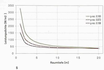
Notwendige Dichte der Kühlleistung in Abhängigkeit von der Raumtiefe für drei verschiedene  $g_{\rm eff}$ -Werte bei 3 m hoher Verglasung und inneren Quellen von  $^{24\,\rm M/m^2}$
