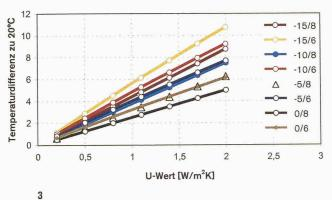
Glasoberflächentemperaturen in Abhängigkeit vom U-Wert und vier verschiedenen Aussenlufttemperaturen (–15, –10, –5 und 0 °C), je für den Wärmeübergangskoeffizienten  $\alpha_i$  = 8 und 6 W/m² K (Legende: Aussenlufttemp./ $\alpha_i$ ). Die Daten aus Bild 2 entsprechen bei –10 °C Aussenlufttemperatur folgenden U-Werten:
