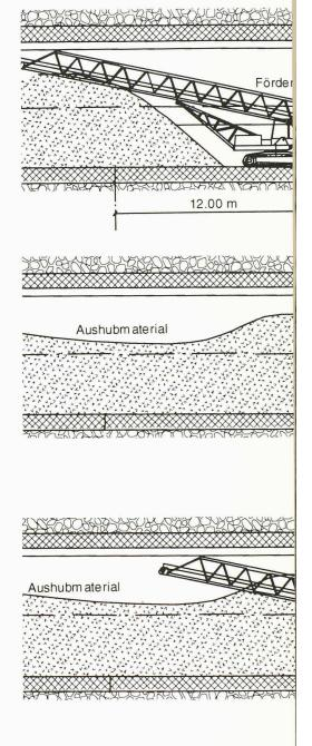
8a, b, c Bauverfahren in der Längsrichtung. Massstab 1:250
