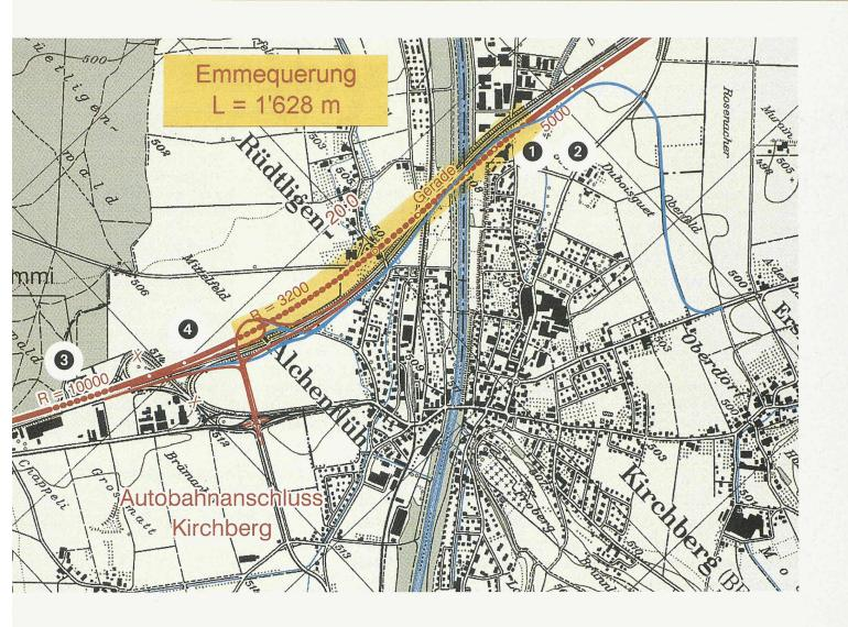
Für die Querung der Emme, der Autobahn und der Eisenbahnbrücke im 295 m' langen Los C kommt die Deckelbauweise zur Anwendung, so dass die zeitlichen Eingriffe auf Verkehr und Fluss reduziert werden können. Die entsprechenden Querschnitte sind in Bild 3 dargestellt.
