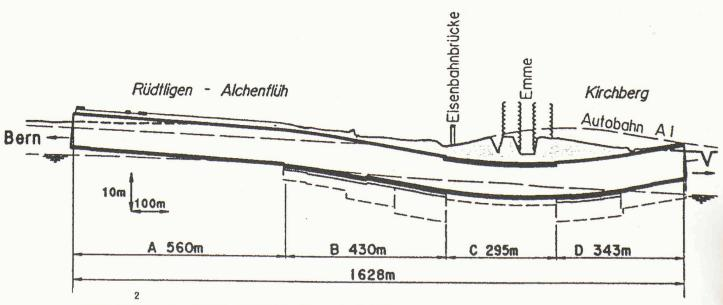
Längsschnitt des Tunnels, Massstab 1:10 000 (Bild und folgende: Marti AG)
