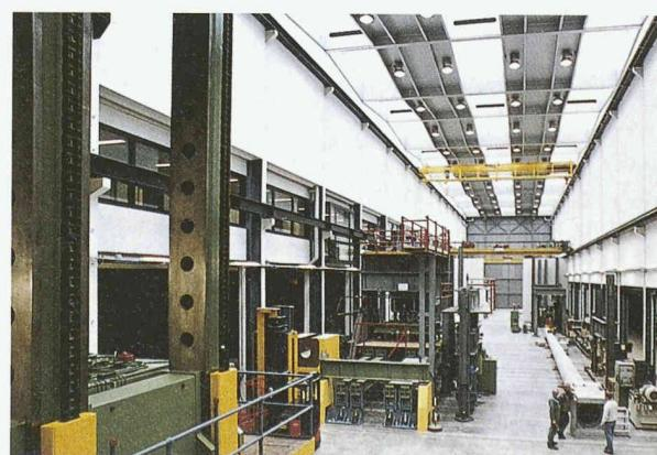
**Prüfen grosser Strukturen: Im Rahmen der Empa-Sanierung wurden die Prüfhalle und das Versuchsfeld markant vergrössert. Mit standardisierten Stahlstützen bzw. -trägern können Versuche beliebiger Geometrien aus den Bereichen Bauingenieurwesen, Fahrzeug- und Maschinenbau sowie Luft- und Raumfahrt aufgebaut werden. (Bild: pd)**
