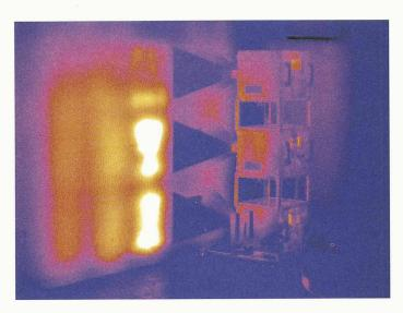
Mikrowellen gegen Wasserschäden: Ein Infrarotbild lässt genaue Rückschlüsse über die Menge und die Lage von Nässe in einer Mauer zu. Bei der Krüger-Methode erzielen durch spezielle Trichter kanalisierte Mikrowellen eine kontrollierte Trocknung von Mauern und Böden von innen nach aussen
