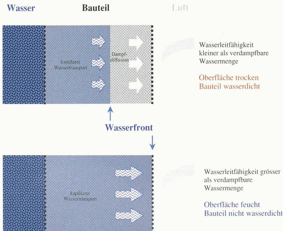
Berechnung der Wasserleitfähigkeit aus der Wasseraufnahme in den ersten 24 Stunden um eine extreme zeitliche Extrapolation handelt.
