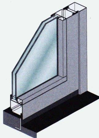
verglasungen erstellen. In baugleicher Ausführung, jedoch wärmege-dämmt, erweitert die Serie Janisol die gestalterischen Möglichkeiten. Das einheitliche Erscheinungsbild ermöglicht es, differenzierte Anforderungen in durchgehender Optik zu erfüllen. In zwei Broschüren präsentiert Jansen AG eine Systemübersicht, die Darstellung des Profilsortiments mit Zubehör sowie technische Erläuterungen. Die Broschüren sind kostenlos erhältlich bei:
