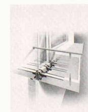
zeitsparende Montage am Bau durch Aufstecken der Zugeisen nach dem Verlegen der Bewehrung (3. und 4. Lage). Mit dem Material werden optimale thermische Kennwerte erreicht (lineare U-Werte ab 0,05 W/mK). Die Kombination von Meterelementen mit 20-cm-Modulen ermöglicht eine gute Längenanpassung.
