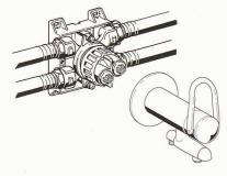
Armaturen. Alle Zapfstellen können optional mit der Einpunkt-Installation versehen werden, unter Verwendung aller gängigen Rohrsysteme. Die Installation des Rohbausets ist lageunabhängig und kreuzungsfrei. Das Stichmass entfällt. Nach Installation der Rohbau- Phase wird das Gesamtsystem nach neusten Normen abgepresst, durchgespült und anschliessend mit dem Bauschutz versehen.
