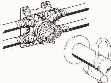
Armaturen. Alle Zapfstellen können optional mit der Einpunkt-Installation versehen werden, unter Verwendung aller gängigen Rohrsysteme. Die Installation des Rohbausets ist lageunabhängig und kreuzungsfrei. Das Stichmass entfällt. Nach Installation der Rohbau-Phase wird das Gesamtsystem nach neusten Normen abgespult, durchgespült und anschliessend mit dem Bauschutz versehen.
