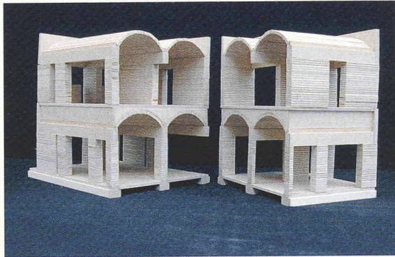
reKonstruktion Le Corbusier, Villa Sarabhai, Ahmedabad, Indien 1955 Öffnungen in der Schottenstruktur (oben links) Konstruktiver Aufbau der einzelnen Schotten (links) Innenraum mit Nachbildung der Oberflächen (oben rechts)
