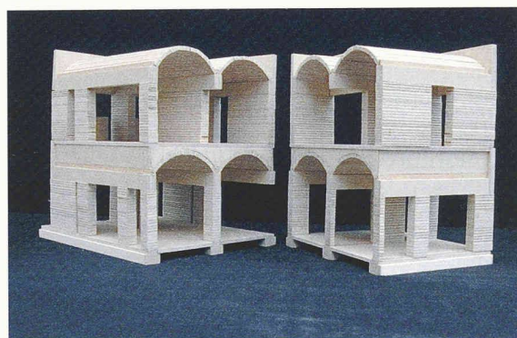
reKonstruktion Le Corbusier, Villa Sarabhai, Ahmedabad, Indien 1955 Öffnungen in der Schottenstruktur (oben links) Konstruktiver Aufbau der einzelnen Schotten (links) Innenraum mit Nachbildung der Oberflächen (oben rechts)
