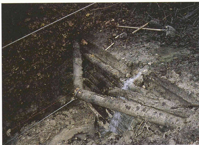
4 Biegebruchversuch an einer einwandigen Holzsperrwand. Das Rundholz ist in Balkenmitte und bei der rechten Einbindung gebrochen (in Fließrichtung betrachtet). Als Kraftquelle diente eine traktorbetriebene Seilwinde
