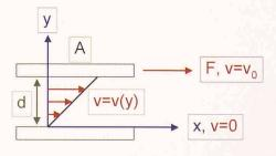
Zwei-Platten-Modell, Definition der Viskosität, mit Schubspannung:  $\tau$  = F / A; Scherrate:  $\gamma$  =  $v_0$  / d für das Zwei-Platten-Modell; Viskosität:  $\eta$  =  $\tau$  /  $\gamma$  für Newton'sche Flüssigkeiten
