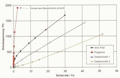
Einfluss von Fliessmitteln auf die Fliesskurve eines Zementleims (CEM I 42.5, w/z = 0,355). Kugelmesssystem (Ø 12 mm)
