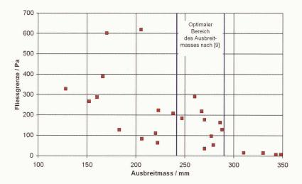
jedoch nicht zu erkennen. Dies lässt sich dadurch erklären, dass das Ausbreitmass nicht nur von der Fliessgrenze, sondern auch von der Viskosität abhängt. Bei geringer Viskosität neigen die Zuschläge – wie oben erwähnt – zum Sedimentieren, das Fliessverhalten verschlechtert sich.
