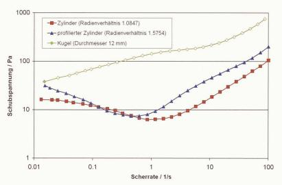
Fliesskurve eines Silikonöls in Abhängigkeit des verwendeten Messsystems
