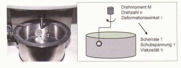
Kugelmesssystem nach Tyrach und Müller für ein Probenvolumen 500 ml; Kugeldurchmesser: 8, 12, 16 mm
