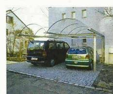
Car-Cupol ist langlebig, denn die Stahlkonstruktion ist feuerverzinkt und die Befestigungsteile sind rostfrei. Das Acrylglas ist lichtecht, witterungs- und alterungsbeständig, gebaut für eine lange Lebensdauer.
