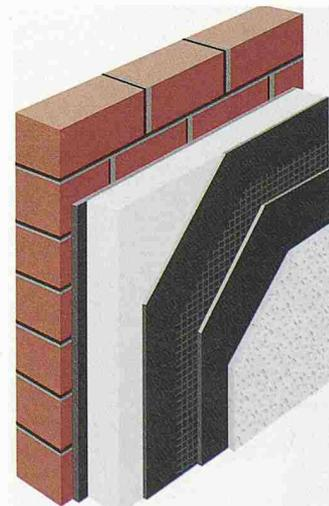
**Der Mantel eines Wärmedämm-Verbundsystems schützt das Haus vor Wärmeverlust. Als Schlussbeschichtung stehen individuell gestaltbare Deckputze zur Verfügung**
