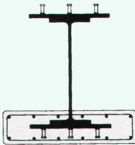
**Geilinger Stahlstützen** F30-F180
