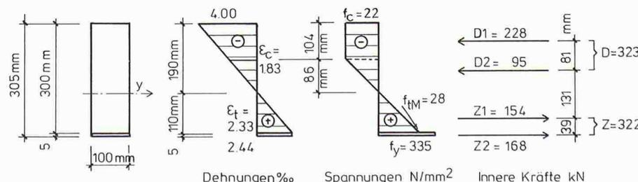
stische Berechnung zeigt ebenfalls, dass die heikle Zugzone - und nicht die duktile Druckzone - die Schwachstelle des Querschnitts bleibt.
