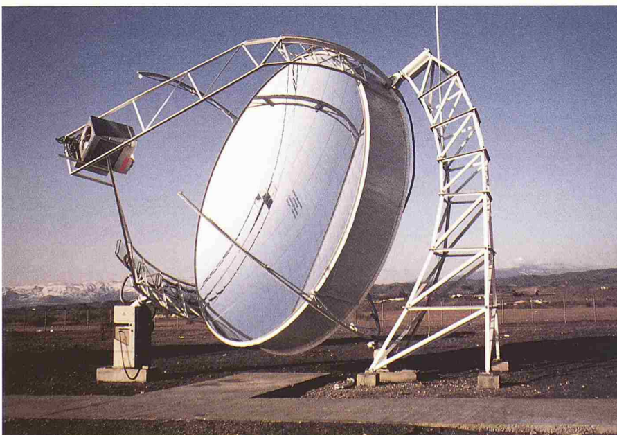
9 kW Dish/Stirling-Einheit auf der Plataforma Solar in Almeria, Spanien, Entwicklung [5] (Bild: Schlaich Bergemann und Partner)
