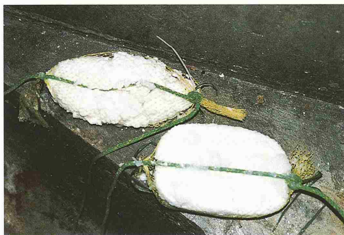
8 Depotsteine (Tabletten und Block) nach dreimonatigem Einsatz
