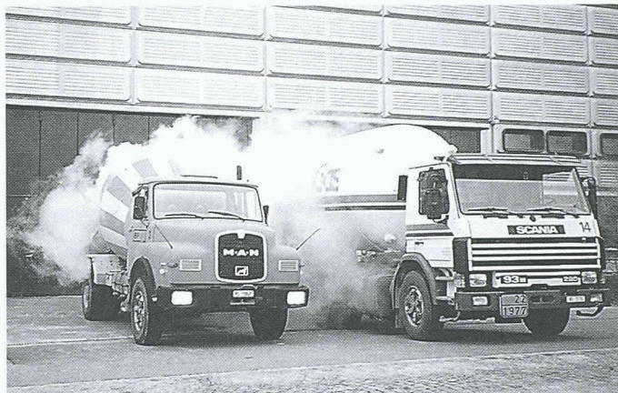
In einem Zisternenwagen wird der Flüssigstickstoff auf die Baustelle transportiert und dort direkt der Betonmischtrommel zugeführt (Bild: ETH Lausanne)
