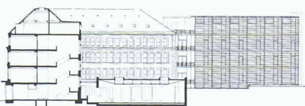
Schnitt Umbau und Aula, rechts Innenhof-Fassade Erweiterungsbau
