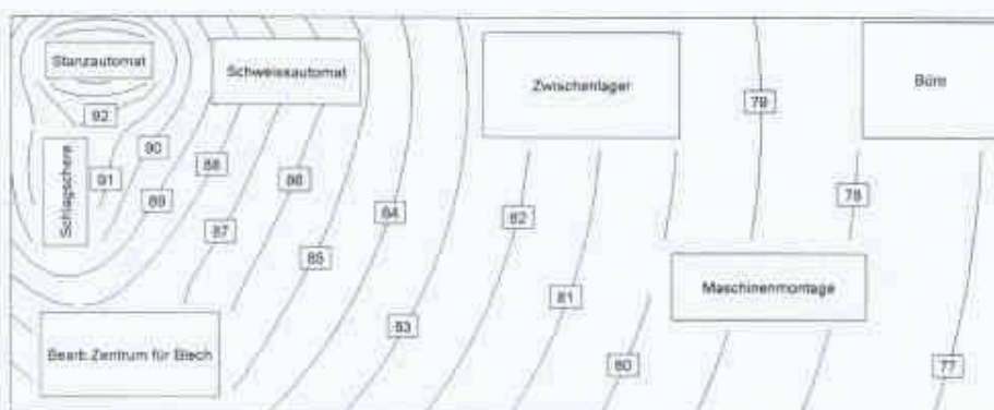
Schallpegelverteilung mit Akustikdecke
