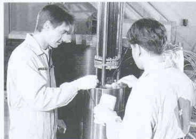
Einfüllen der Glasfaserschnitzel in die Stahlhülse
