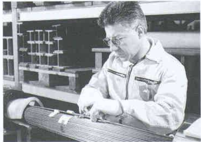
Aufbringen von Sensoren für die Langzeitmessungen
