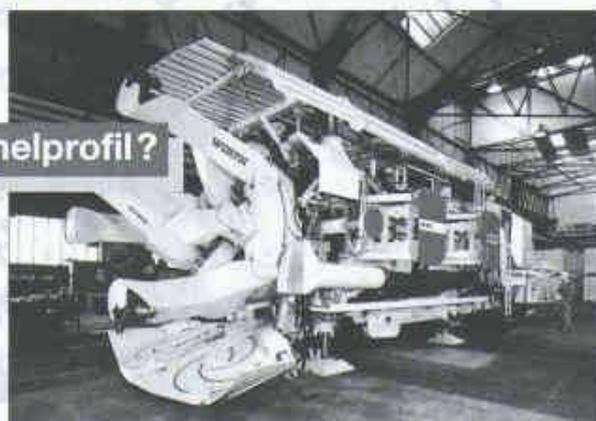
Wir bieten Ihnen für alle Gesteins- und Untergrundformationen die passende Tunnelvortriebsmaschine von 2 - 15 m Bohrdurchmesser. Mit unserer neuen, mobilen Tunnelvortriebsmaschine Typ MTM sind Sie in der Lage auch unkonventionelle Querschnitte aufzufahren.
