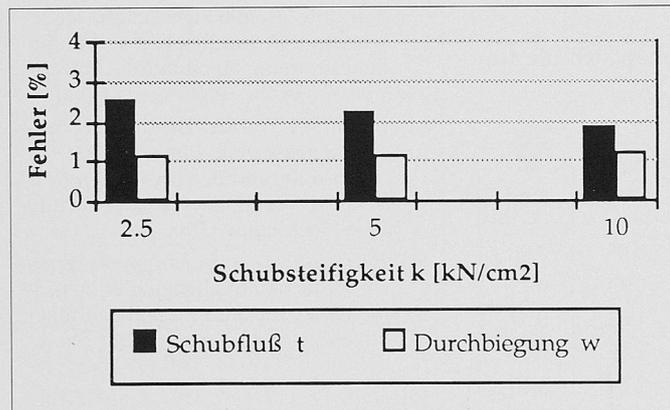
Bild 13. Fehler der Näherungslösung bei Einzellasten  $P = 2 \times 5 \text{ kN}$  in den Drittelpunkten
