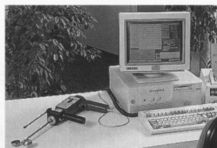
PC-Anschluss garantiert belegbare Betonqualität.
