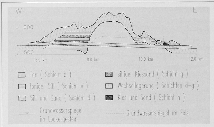
Bild 1. Geologisches Längenprofil mit Molasse-Lockergestein und Grundwasserständen (Bild: Geologisches Institut, Bern)
