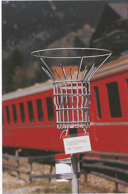
Bild 6. Eine Station des Messnetzes mit Bergerhoff-Topf im Vogelschutzgitter und mit Passivsammlern (Photo: Oberli, Klosters)
