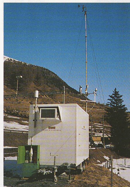
Bild 2. Luftschadstoff-Messwagen mit Meteomast (Photo: I. Sommer, BfÖ)
