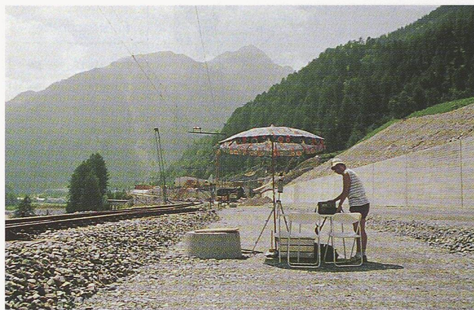
Bild 12. Lärm-Messtation auf dem Gelände des zukünftigen Verladebahnhofs Susch-Lavin (Photo: I. Sommer, BfÖ)
