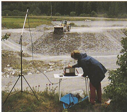
Bild 8. Eine Lärm-Messstation am Rande der ehemaligen Kiesgrube Muligné, Zernez (Photo: I. Sommer, BfÖ)
