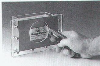
Beim kreuzweisen Einschneiden einer Panele dichtet das Natrium-Bentonit die Beschädigung spätestens in einer Minute komplett ab.
