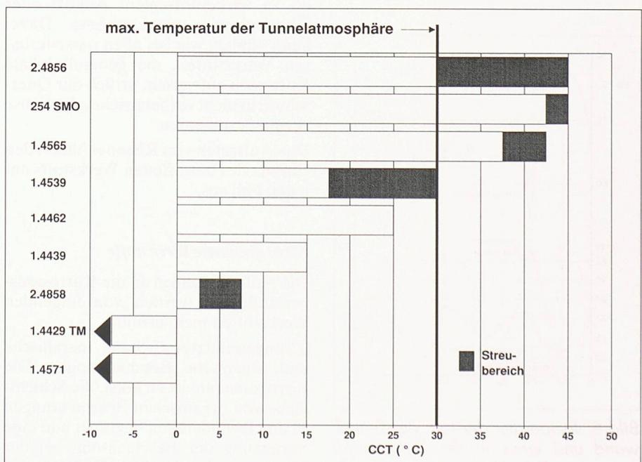
Bild 6. Spaltkorrosionstest in 10%-FeCl<sub>3</sub>-Lösung
