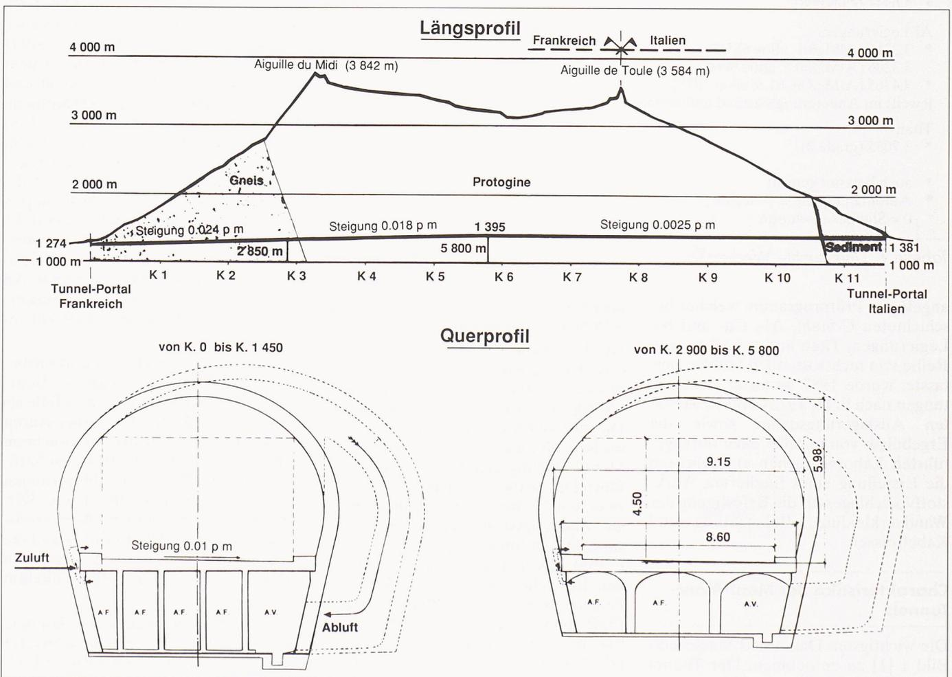
Bild 1. Bauweise und kennzeichnende Daten des Mont-Blanc-Tunnels
