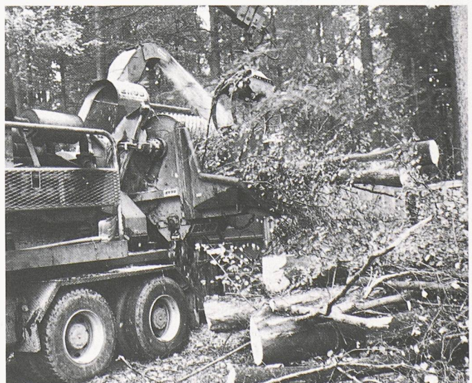
Abfallholz wird direkt im Wald zu Holzschnitzeln verarbeitet, die dann in den Schnitzelöfen verbrannt werden (Bild: Comet)
