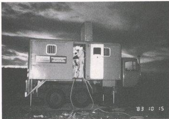
Bild 9. Drucksondierungen unter Vollatemschutz (Deponie Gersheim, Deutschland)
