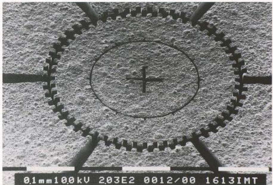
Rasterelektronenmikroskopische Aufnahme des Schrittmotors. Der Läufer des Schrittmotors ist von 6 Statorelementen umgeben, wobei die Rotation des Läufers durch das elektrische Wechselfeld zwischen den Zahnkränzen von Läufer und Statorelementen erzeugt wird. Die Drehfrequenz des Läufers ist variierbar vom Einzelschrittbetrieb bis 3400 Umdrehungen pro Minute
