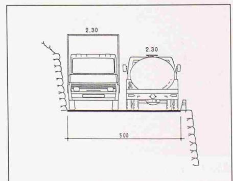
Bild 5. Begegnungsfall LW-LW im heutigen Normalquerschnitt
