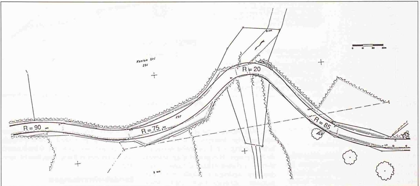
Bild 7. Projektierte Linienführung mit Minimalradien von 20 m
