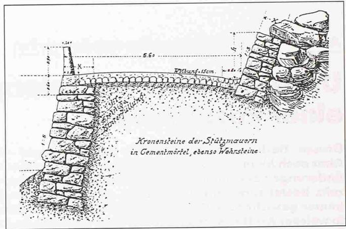
Bild 4. Querprofil aus den Baunormalien von 1891
