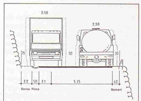
Bild 9. Querschnitt und Kreuzungsmöglichkeiten in unübersichtlichen Kurven
