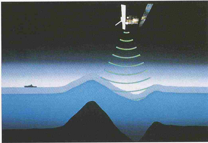
Bild 4. Graphische Darstellung, wie mit Hilfe des ERS-1-Satelliten die submarine Topographie untersucht wird. Courtesy of: ESA/Archiv Schmidt.
