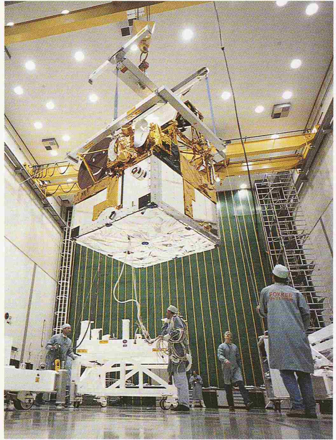
Bild 8. Nutzlastmodul mit wissenschaftlichen Experimenten. Die Struktur wurde durch Contraves in Zürich gebaut. Courtesy of: ESA/Archiv Schmidt.
