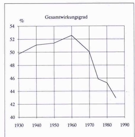
Bild 2. Entwicklung des Umwandlungswirkungsgrades von Primärenergie in Nutzenergie
