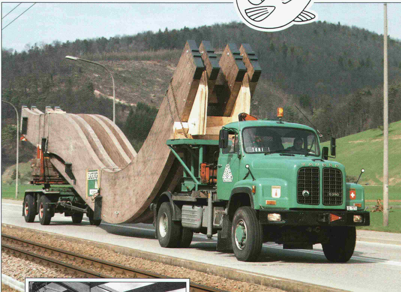
Unterwegs mit den Hauptbogenträgern für das Hallenschwimmbad «Nid-du-Crô» in Neuchâtel.
