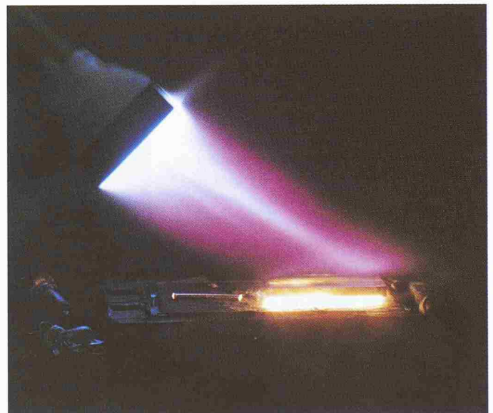
Auf den schräg angeordneten Sinterkörper (links) trifft der ultraviolette und deshalb unsichtbare Laser-Strahl. Er löst dort Atome und Atomverbände (Cluster) ab, die zum waagrecht liegenden, gelblich leuchtenden Substrat (unten) fliegen und ihren Weg durch violettes Plasmaleuchten verraten (Bild: KFA)
