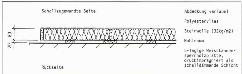
Bild 2. Standardaufbau für die Messungen des IPH-Projekts «Schallschutzwände»
